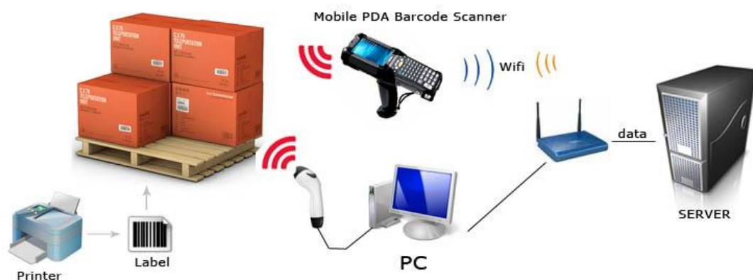
รูปที่ 2-3 ขั้นตอนการทำงานของเครื่องอ่านบาร์โค้ด
