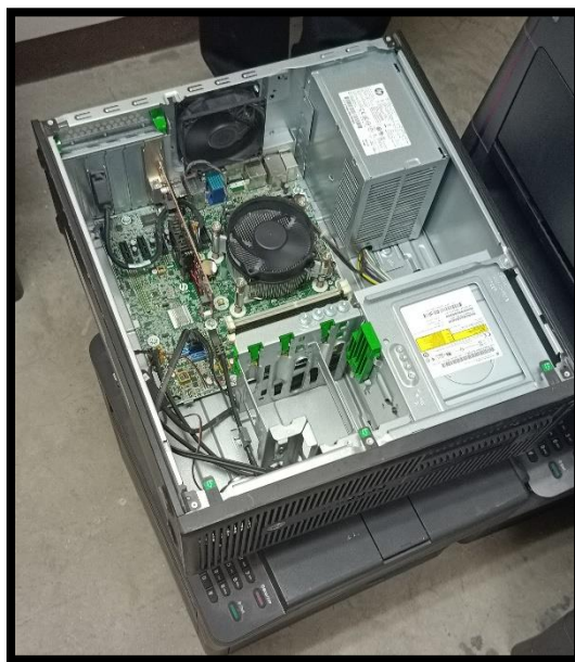
ภาพที่ 3-1 ตรวจสอบ power supply
