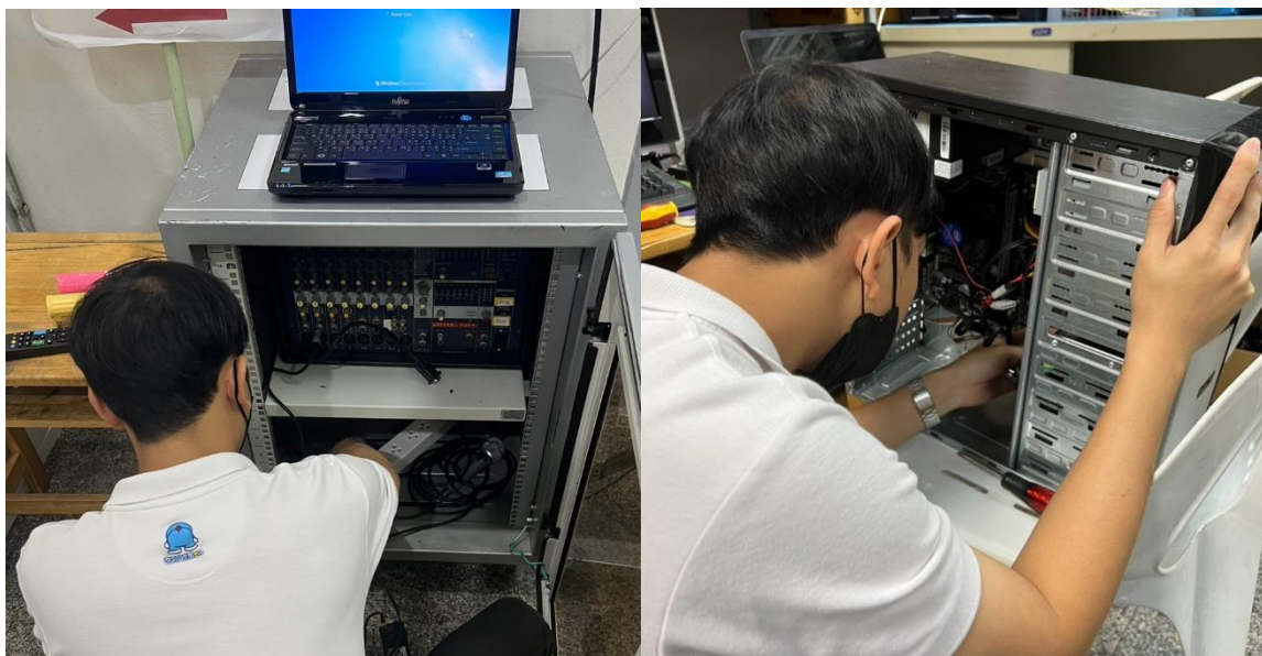
ภาพที่ 3-56 ทำความสะอาดเครื่องเสียงและคอมพิวเตอร์
